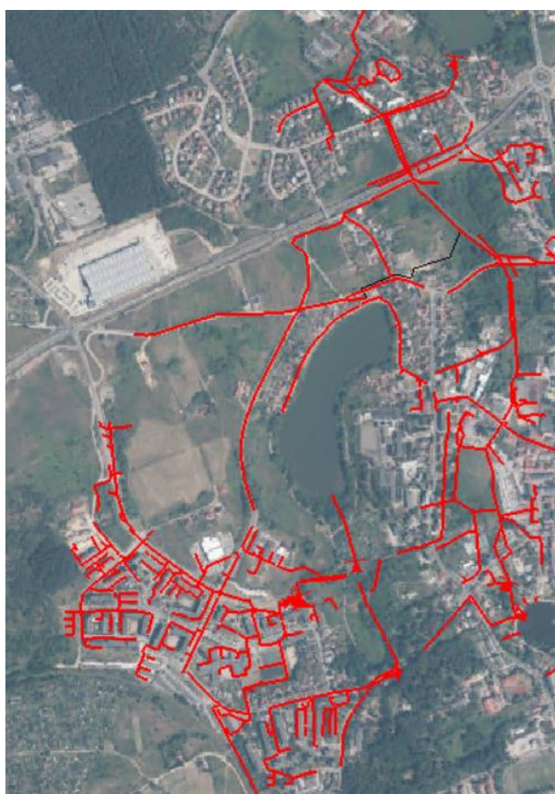
Rysunek 2 Schemat istniejącej sieci kanalizacji deszczowej
